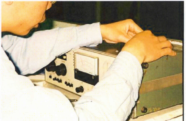
Qメーターで空芯コイル測定中(今回の試作)
