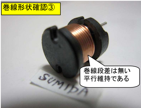
リード終端処理確認: 巻線終端部
